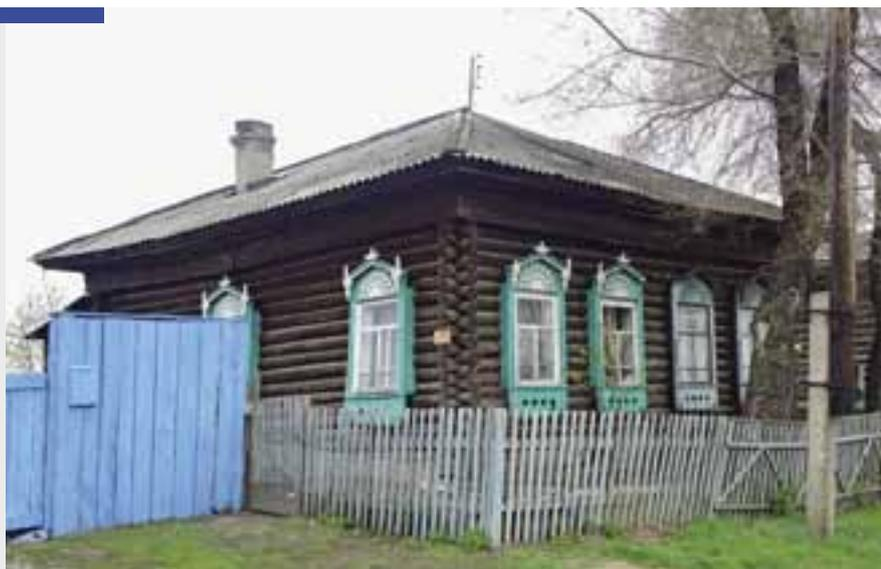
Внешние края карниза оформлены пропильными свесами, нижний край подчеркнут зубчиками. Фартук наличника набран из вертикальных дощечек, завершенных свесами с полуциркульным очертанием, пропилы между смежными дощечками образуют горизонтальный ритм с растительным узором.
