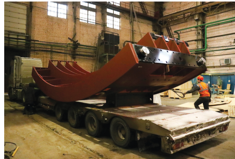
Отгрузка одного из шести секторов корпуса статора гидрогенератора для Майнской ГЭС
