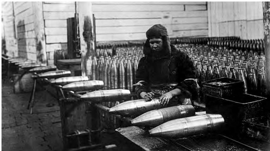
Завод № 65 им. Сталина. Поточное производство 122-мм осколочно-фугасных гаубичных снарядов Применение ската в цехе доделочных операций. Передача корпусов на укупорку 33
