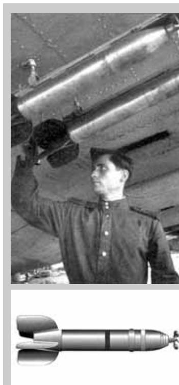
Реактивные снаряды РС-82 под крылом Ил-2
