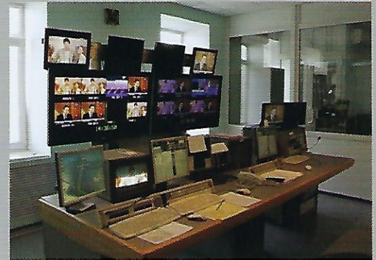
АЦ-КРА ГТРК «Новосибирск». Может выдавать в эфир до 4 телевизионных программ.
